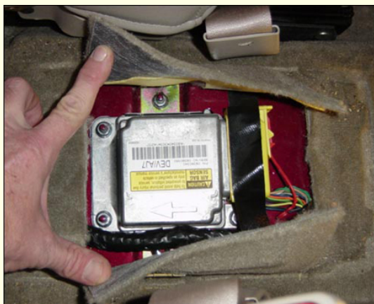
Foto 3 Dispositivo EDR instalado entre os assentos (NextAutos, 2006)
