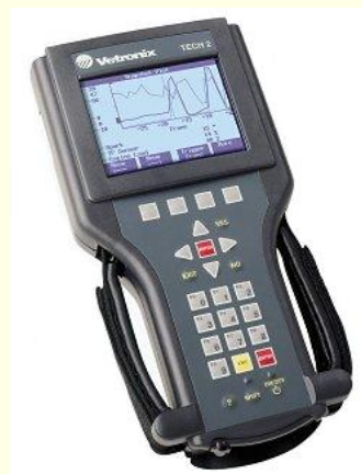
Foto 4 Coletor de dados GM Tech 2 (Airbagcrash, 2008)
