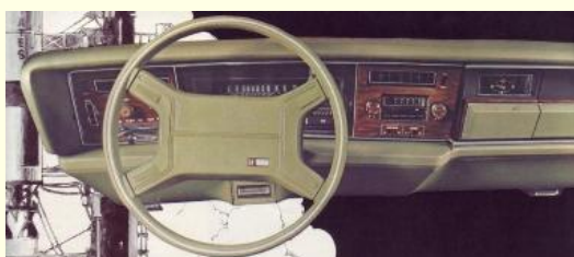
Foto 1 Dispositivo air bag com EDR no painel do Oldsmobile Toronado 1974 (AIRBAGCRASH, 2008).
